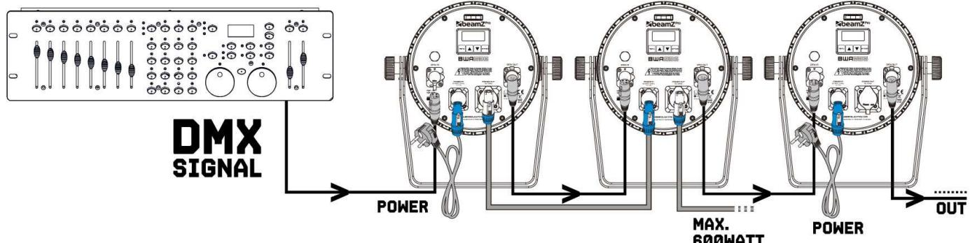
**ATTENTION!** sur le dernier appareil, vous devez terminer la ligne DMX avec une résistance. Prenez un connecteur XLR et soudez une résistance de 120 ohms entre le signal (-) et le signal (+) et connectez-la à la sortie DMX du dernier appareil sur la ligne.
