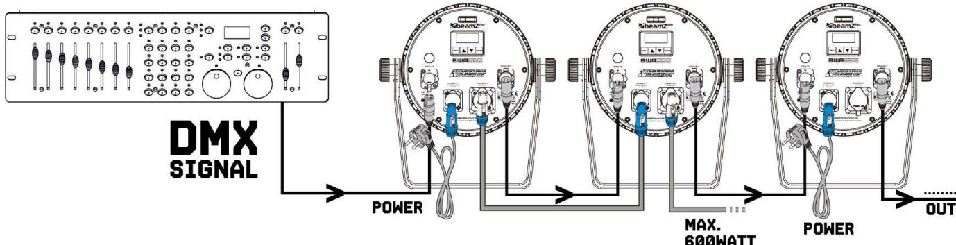
**UWAGA!** Na ostatnim urządzeniu musisz mieć linię DMX z rezystorem końcowym. Weź złącze XLR i przylutuj rezistor 120 Ohm między sygnałem (-) a sygnałem (+) i podłącz go do wyjścia DMX ostatniego urządzenia w linii.
